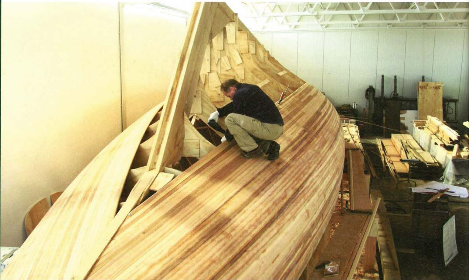
Der Rumpf wird aus verklebten Holzleisten gebaut. Trotz moderner Bautechnik eine Herkulesaufgabe für einen einzelnen Mann //
