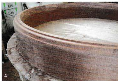
1 De onderste hoepel van het ronde dekhuis wordt rond een mal gelamineerd • 2 De onderste hoepel is klaar • 3 De massieve lijst in aanbouw • 4 Het massieve deel tussen de onder- en bovenhoepel • 5 De kleinere hoepel op de lijst • 6 Top waarin ruiten liggen wordt gemaakt • 7 Spijlen voor 12 ruiten • 8 Het gelakte eindresultaat
