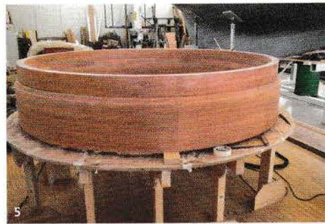
1 De onderste hoepel van het ronde dekhuis wordt rond een mal gelamineerd • 2 De onderste hoepel is klaar • 3 De massieve lijst in aanbouw • 4 Het massieve deel tussen de onder- en bovenhoepel • 5 De kleinere hoepel op de lijst • 6 Top waarin ruiten liggen wordt gemaakt • 7 Spijlen voor 12 ruiten • 8 Het gelakte eindresultaat
