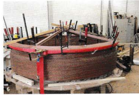
1 De onderste hoepel van het ronde dekhuis wordt rond een mal gelamineerd • 2 De onderste hoepel is klaar • 3 De massieve lijst in aanbouw • 4 Het massieve deel tussen de onder- en bovenhoepel • 5 De kleinere hoepel op de lijst • 6 Top waarin ruiten liggen wordt gemaakt • 7 Spijlen voor 12 ruiten • 8 Het gelakte eindresultaat
